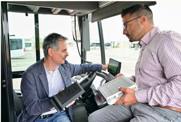
Einbau neuer Technik: Fahrgäste zählen in Echtzeit.
