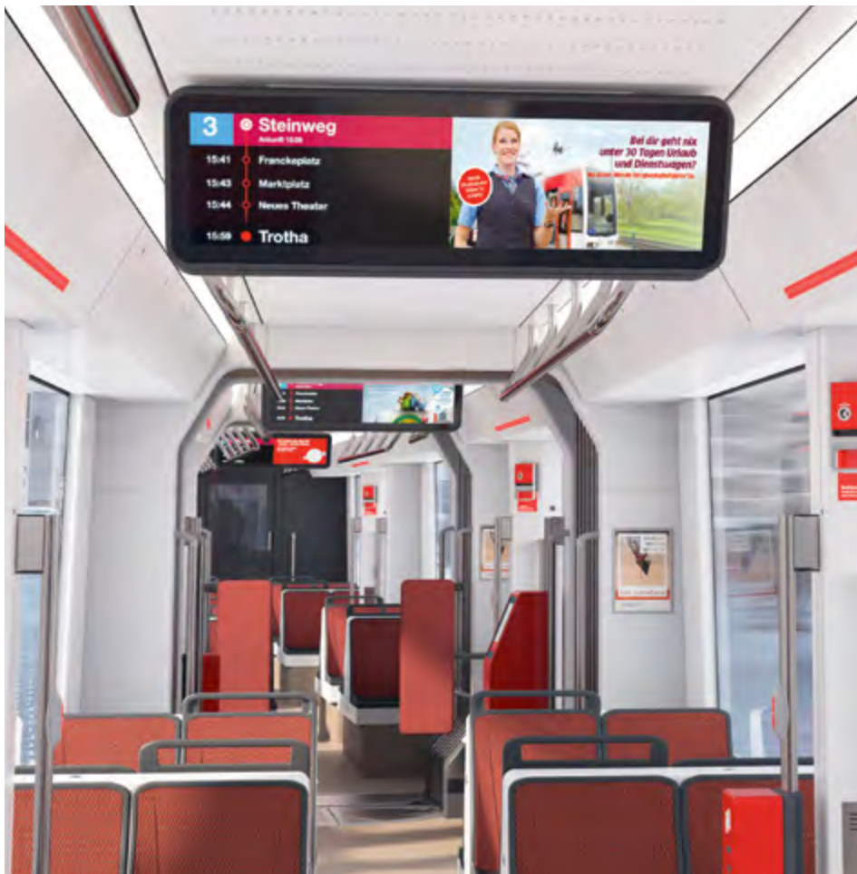
Infos immer im Blick: Fahrgastinformationsanzeigen sind in allen Türbereichen installiert.
