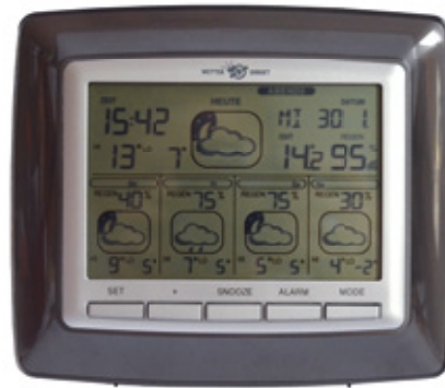
Die Funkwetterstation TFA verfügt über eine satellitengestützte WETTERdirekt-Technologie, 36 Wettersymbole und ermöglicht eine vier-Tage Wettervorhersage.
